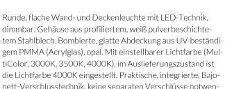
tiColor, 3000K, 3500K, 4000K), im Auslieferungszustand ist die Lichtfarbe 4000K eingestellt. Praktische, integrierte, Bajonett-Verschlusstechnik, keine separaten Verschlüsse notwendig. 3-polige Anschlussklemme mit Steckkontakt, Durchschleifen möglich, 2 Kabeleinführungen. Geeignet für die Montage an Wand und Decke oder gependelt mit 3-Punkt-Seilabhängung. Zugelassen für den Einsatz in Innenbereichen.
