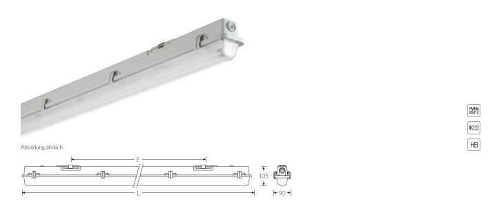
Feuchtraumwannenleuchte für LED-Röhre. Kurzschlussschutz dank eingebauter Feinsicherung. Leuchtenunterteil aus glasfaserverstärktem Polyester, hellgrau, schwer entflammbar. Wanne aus UV-beständigem Polymethylmethacrylat (PMMA), geperlt. Wannenverschluss aus Edelstahl. Multifunktionale Schnellmontage mit Befestigungsklammer aus Edelstahl (Leuchte einklipsbar). Ausrichten der Leuchte durch den variablen Verschiebebereich um 60 mm.
