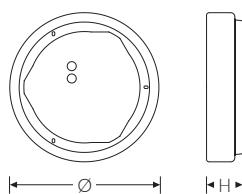
Runde LED-Anbauleuchte, mit einstellbarer Lichtleistung (MultiLumen), im Auslieferungszustand ist der Maximalwert eingestellt. Geeignet für die Montage an Decke und Wand. Gehäuse aus profiliertem, weißlackiertem Stahlblech. Zylindrische, glatte Abdeckung aus UV-beständigem Polymethylmethacrylat (PMMA), opal. Sicherer Halt der Abdeckung durch Federverchluss. 3-polige Anschlussklemme mit Steckkontakt, Durchschleifen möglich. 2 Kabeleinführungen.
