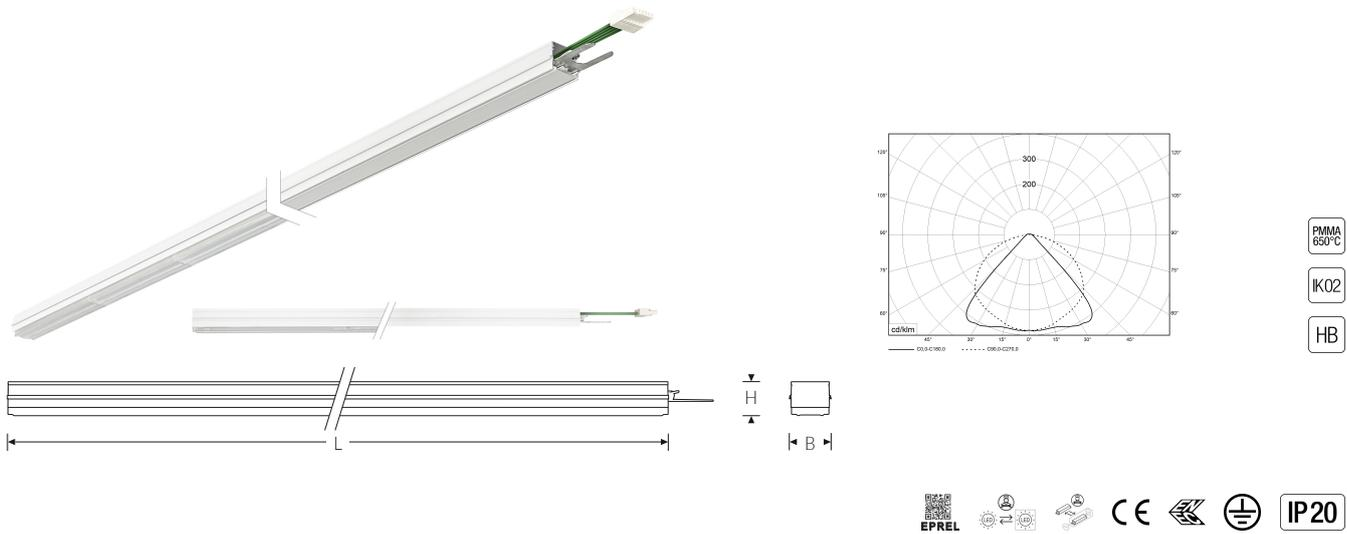
TRF LED-Lichtleiste mit einreihiger, linearer Lichtoptik aus PMMA, dimmbar. Wide Beam, 90° Abstrahlwinkel. Tragschiene und Lichteinsatz sind eine Einheit. Gehäuse aus profiliertem Aluminium mit Durchgangsverdrahtung, Stecksystem und Schnellverschlüssen.
