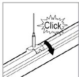
4. Legen Sie die Schienenbefestiger auf die TRF-Lichtleisten und drücken Sie sie, bis Sie ein Klicken hören.
