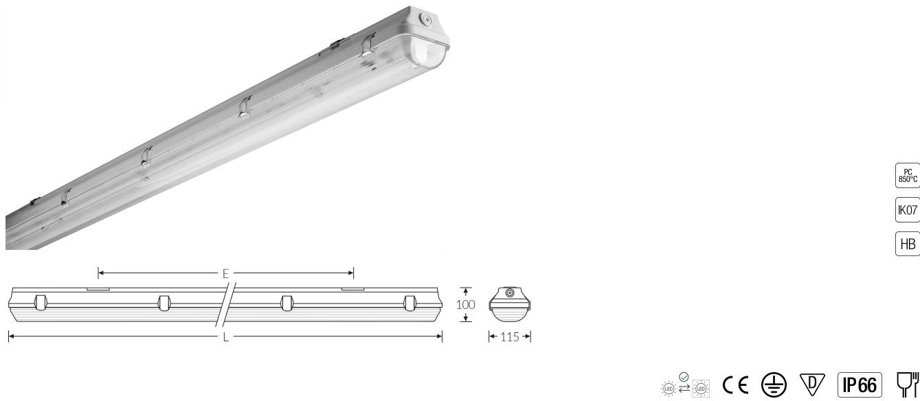
Feuchtraumwannenleuchte für LED-Röhre. Kurzschlusschutz dank eingebauter Feinsicherung. Leuchtenunterteil aus glasfaserverstärktem Polyester, hellgrau, schwer entflammbar. Gespritzte Polycarbonat (PC)-Wanne mit Innenprismen. 3-tlg. Edelstahl-Verschlüsse. Multifunktionale Schnellmontage mit Befestigungsklammer aus Edelstahl (Leuchte einklipsbar). Ausrichten der Leuchte durch den variablen Verschieberegion um 60 mm.
