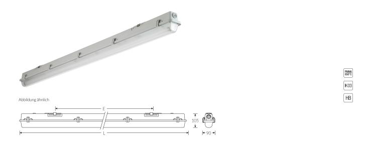
Feuchtraumwannenleuchte für LED-Röhre. Kurzschlussschutz dank eingebauter Feinsicherung. Leuchtenunterteil aus glasfaserverstärktem Polyester, hellgrau, schwer entflammbar. Wanne aus UV-beständigem Polymethylmethacrylat (PMMA), geperlt. Wannenverschluss aus Edelstahl. Multifunktionale Schnellmontage mit Befestigungsklammer aus Edelstahl (Leuchte einklipsbar). Ausrichten der Leuchte durch den variablen Verschiebebereich um 60 mm.
